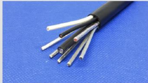
同軸入り複合ケーブル (同軸75Ω × 1本 + 電源 × 2本 + 信号線 × 6本)
